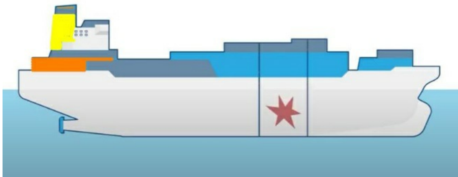
Figurur 0402 Lasteskipet får skade i en avdeling. Skade merket med rød stjerne
