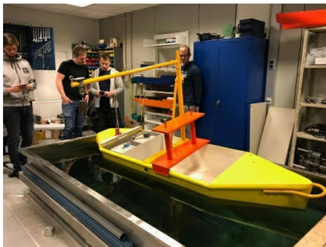
Figur 0258 med tungløft og kontravekt ( \varphi s 5° Styrbord)
