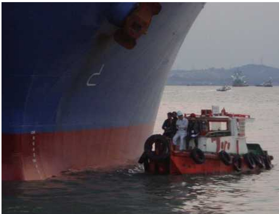
Figur 10.24 viser hvordan et Draft survey utføres der personer fra land og skip er med for å lese av dypgående.
