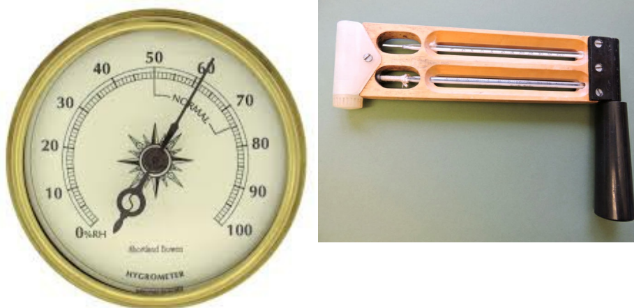
Figur 07.08 viser et bilde av et hygrometer ( til venstre) og psykrometer ( til høyre)
