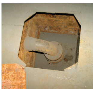
Figur 10.10 viser et bilde av en lensebrønn og et en profilskisse av en lensebrønn
