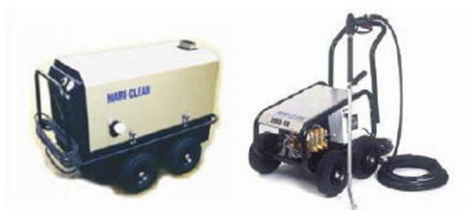
Figur 10.09 viser typiske hjelpemidler til rengjøring av lasterom, en «Toby gun» opereres på høyt trykk fra 9 – 11 bar, den må betjenes av 2 personer på grunn av sikkerhetsmessige hensyn. Bilde av transportabelt HP ferskvannpistol (alle foto fra Strømme shipping Singapore).
