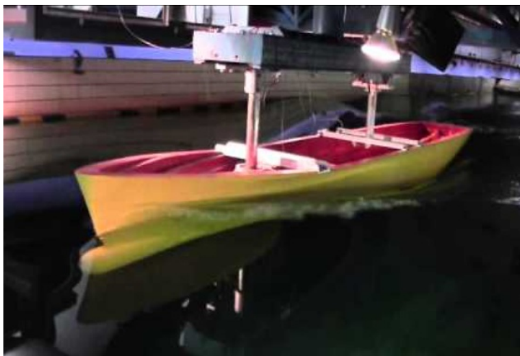
Figur 0129 .iser en modell som blir slept i et basseng, etter en slepevogn som går på skinner, bassenget er utstyrt med bølgegenerator.
