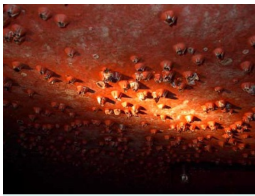
Figur 0131 viser skjellvekst bunns på et skip.
