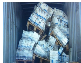
Figur 0917 Viser mangelfull stuasje
