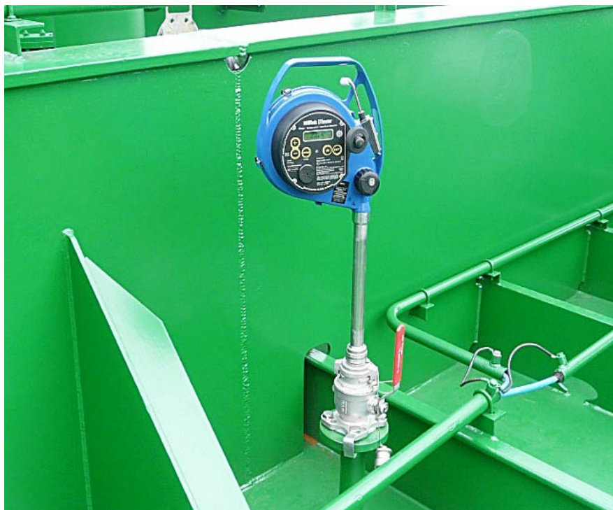
Figur 8.13 Hermetic UTI koblet til ullasjeplugg
