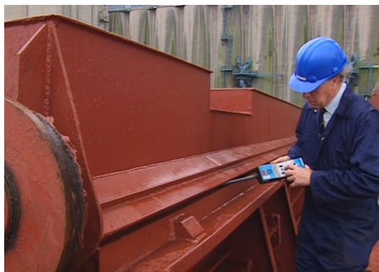
Figur 10.18 Viser hvordan man utfører en ultra test. Senderener plassert på toppen av lasten (Ultralyd test) En operatør med en ultralyddetektor kontrollerer om det er lekkasjer i fra utsiden. Alle bilder vedrørende lukepakning tester tilhører UK P&I Club.
