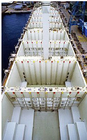
Figur 6.19 Bilde av et lasterom med celleguide, bilde tatt fra wikipedia.
