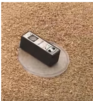
Figur 10.18 Viser hvordan man utfører en ultra test. Senderener plassert på toppen av lasten (Ultralyd test) En operatør med en ultralyddetektor kontrollerer om det er lekkasjer i fra utsiden. Alle bilder vedrørende lukepakning tester tilhører UK P&I Club.
