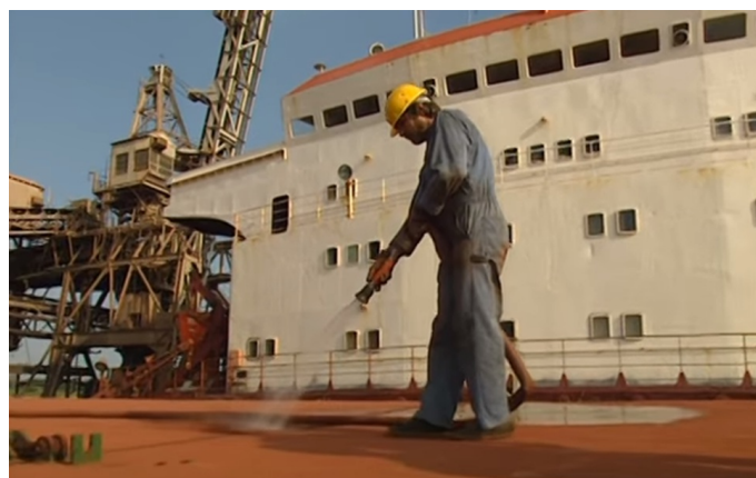
Figur 10.17 Viser hvordan man utfører en vanntest.
